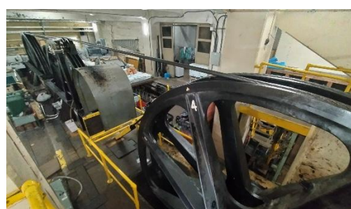
巻上場内の巻上装置（直径4 mの大滑車）
